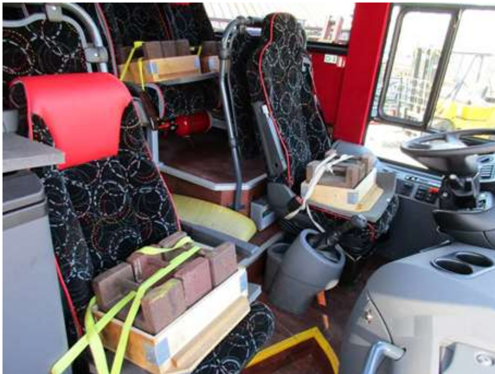
2. ábra Vezetőt és utaskísérőt helyettesítő műterhelések
